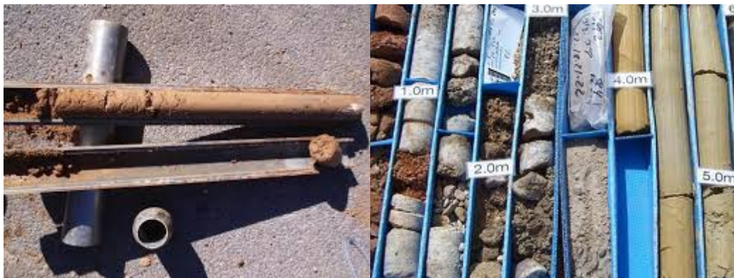
Tubo de ejecución de sondeos con muestras.
